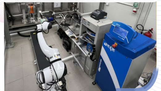
自動混凝土磚測試系統能夠自動化完成混凝土磚從護養到測試的整個流程，並透過減少重複性的人手操作，顯著提升職安健水平。
