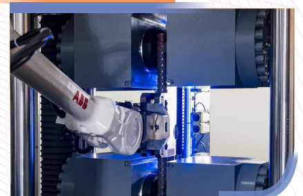
自動鋼筋測試系統採用光學引伸計，省卻拉力測試中的人機互動。
