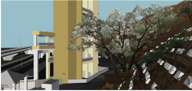
為現有樹木進行雷射掃描，並結合建築信息模型，以設計園景和規劃修枝工作。
