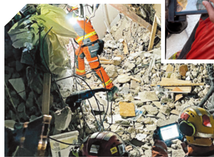
救援隊員以超寬頻雷達技術及三百六十度搜索鏡頭探測瓦礫下是否有生命跡象，有關儀器對呼吸及微細動作最遠探測距離分別為十米及十二米。(相片由消防處提供)
