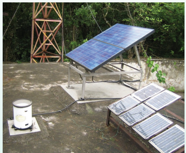
使用太陽能等可再生能源的自動氣象站。
