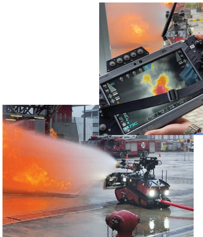
滅火機械人操作員利用遙控器的熱成像顯示功能，遙距監測火源狀況並進行滅火工作。
